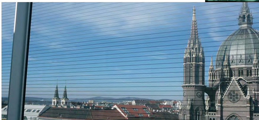
Perception obtenue grâce à des lignes noires horizontales d'une épaisseur de 2 mm avec un espace de 28 mm
